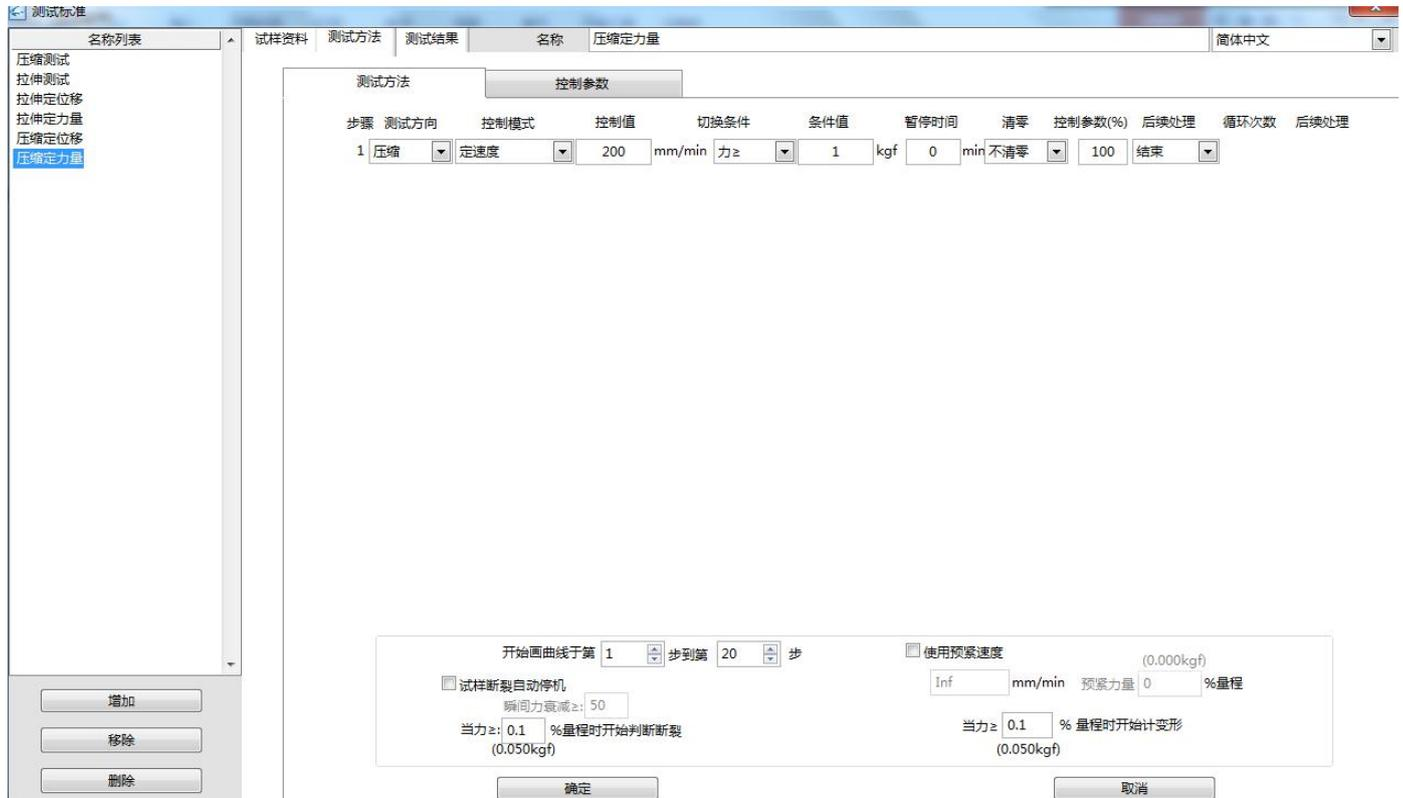
测试方向：设置测试时机台运动方向；
