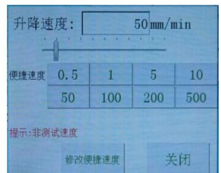
校准机台速度前请先校准位移传感器，如果没有校准位移，速度是校不准的。
