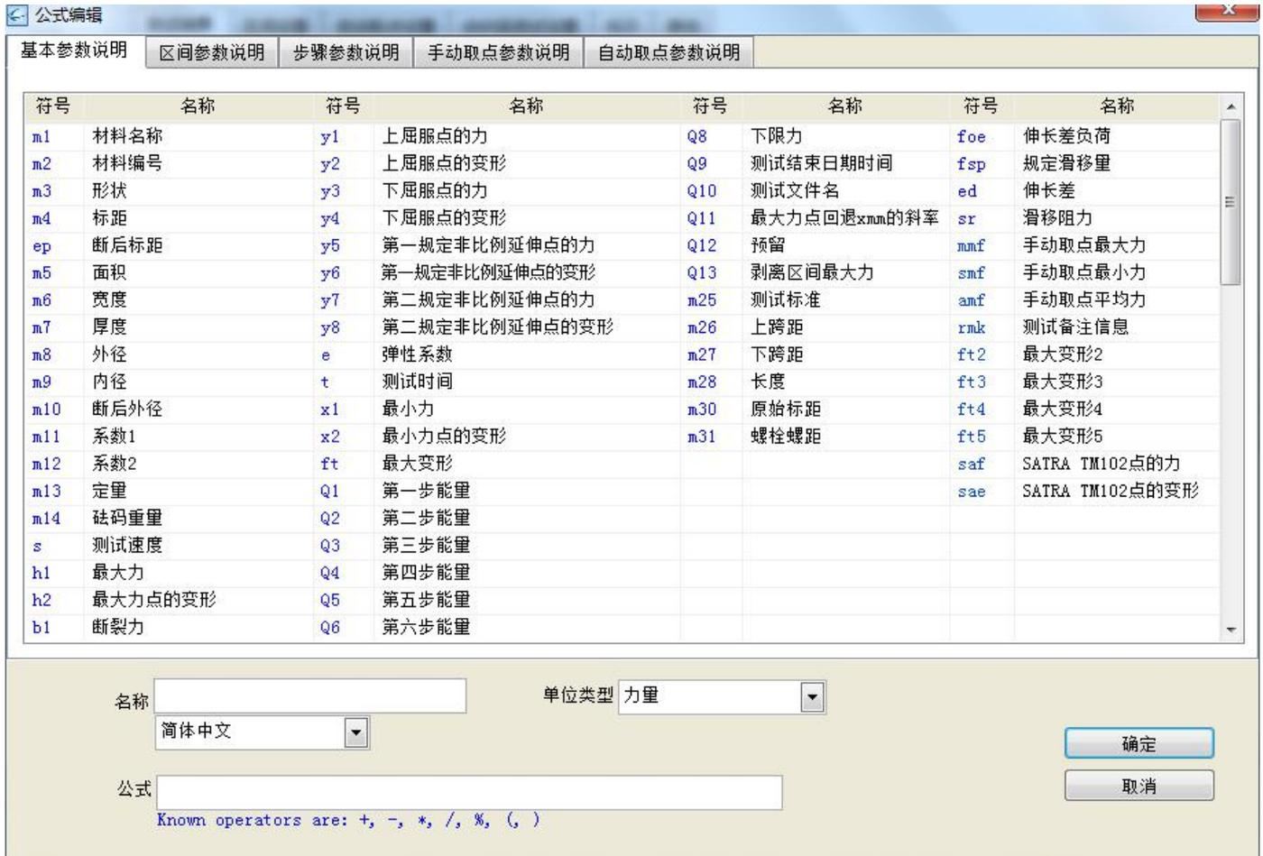
名称为拉伸强度，因  $\text{拉伸强度} = \text{最大力} / \text{面积}$ ，在上面表格中查找最大力的代替符号为 h1，面积的代替符号为 m5，所以公式为 h1/m5，单位类型为应力（强度），确定后参数编辑算完成。表格中列表为基本参数符号说明，供用户测试结果基本参数对应的符号，用于客户编辑公式。
