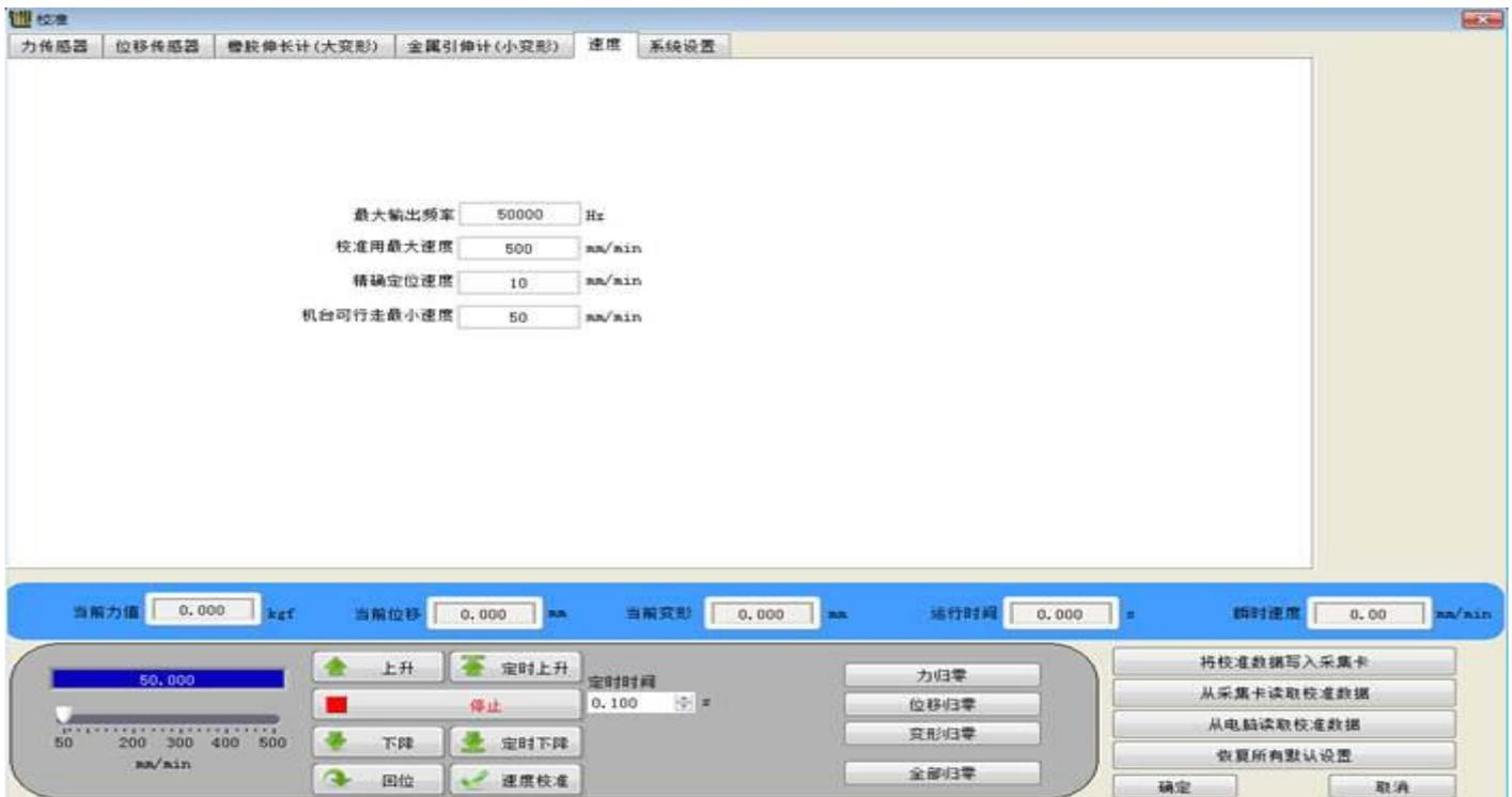
校准机台速度前请先校准行程传感器，在校准速度之前请务必先将“测试前设置项”->“控制方案选择”->“控制参数”页面中的“速度闭环控制”前的“勾”去掉，否则无法进行速度校准。
