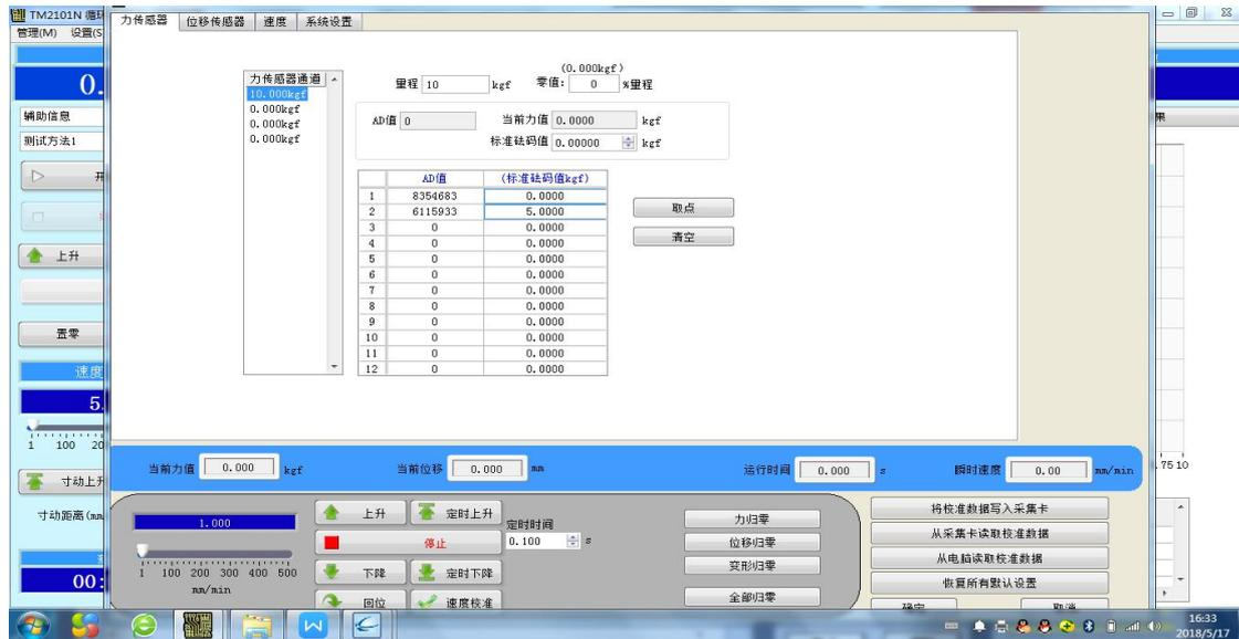
选择力传感器通道，如上图所示。左侧显示的力传感器通道共有四个：“10kg”、“0.0kg”、“0.0kg”、“0.0kg”。
