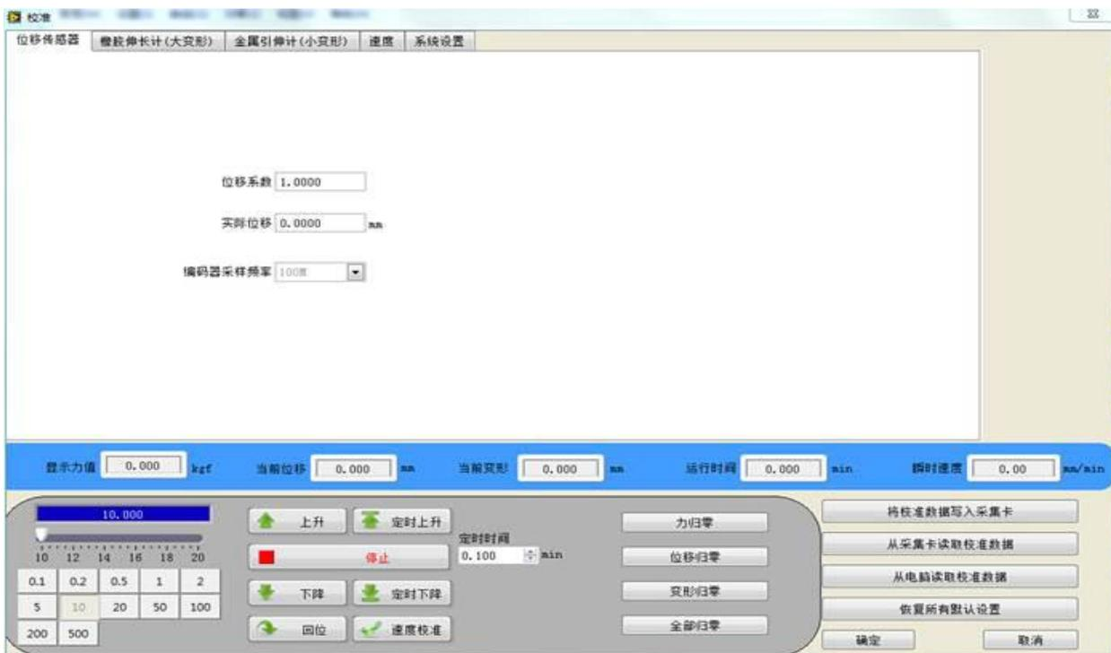
1. 点击“位移归零”按钮，将“当前位移”归零；
